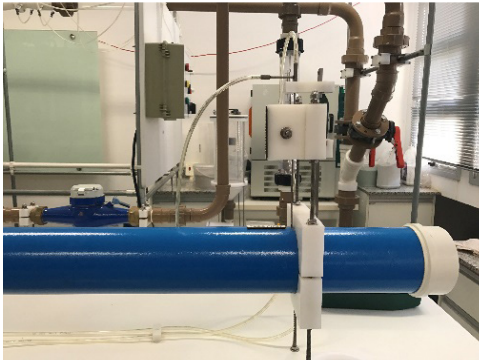
Figura 1 – Tubo de Pitot instalado
